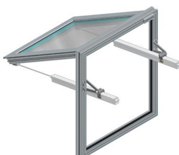
Rys. 12 Okno oddymiające mcr OSO THERM 75 z dwoma siłownikami wrzecionowymi G z przesuniętym punktem obrotu
